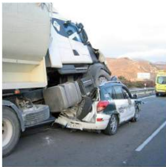
FIGURA 10.1. El «alcance» es un tipo de colisión entre vehículos en el cual un vehículo impacta sobre la parte posterior del que le precede. Con frecuencia es debido a distracciones por parte del conductor del vehículo que golpea.
